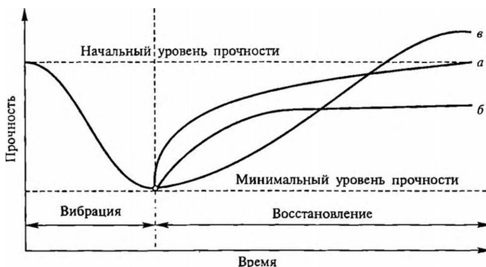
Рис.3Схема восстановления прочности тиксотропной системы (а) и квазитиксотропных природных грунтов (б, в)
