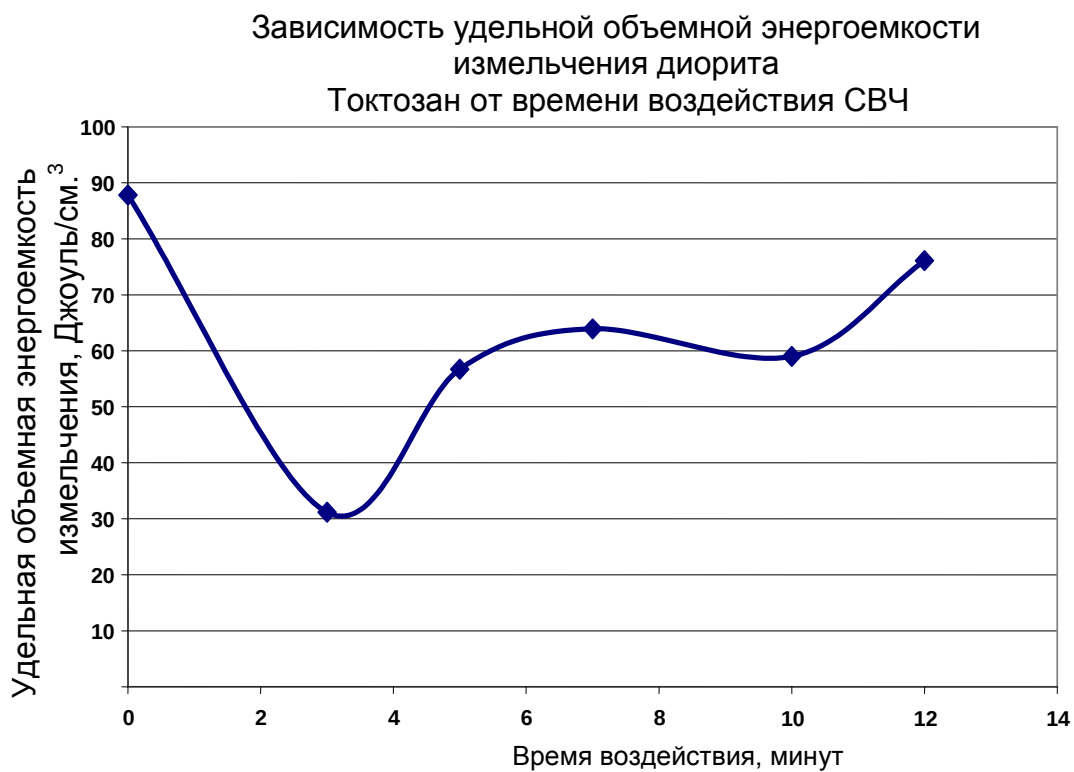
Рис. 2. Зависимость удельной объемной энергоемкости измельчения диорита
