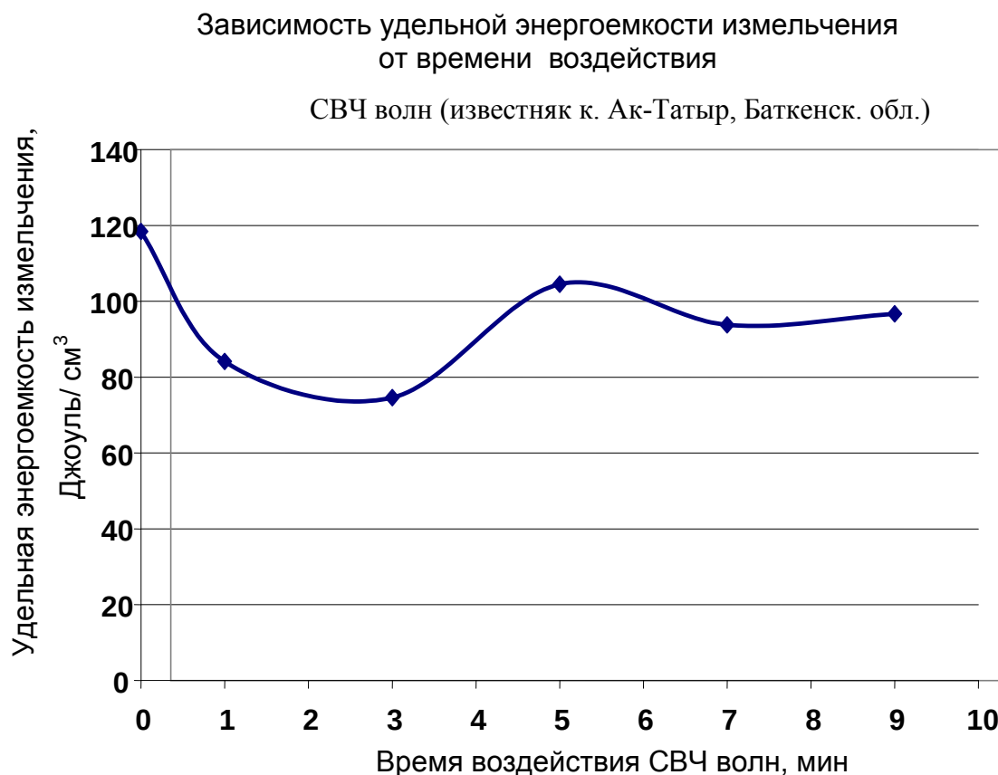
Рис. 1. Зависимость удельной энергоемкости измельчения от времени воздействия
