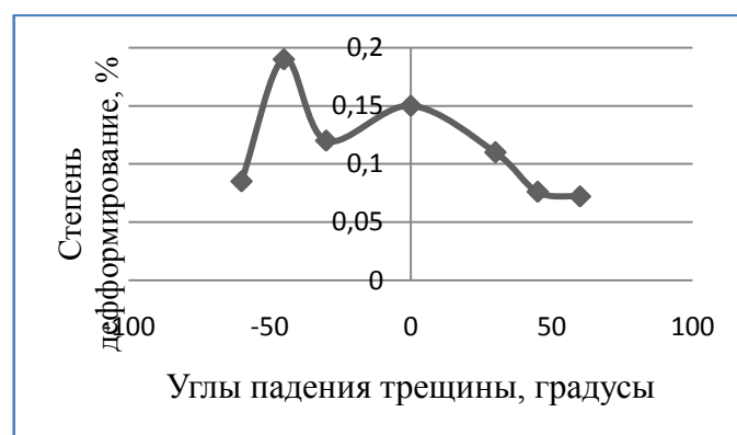
График 2. Изменение степени деформирования относительно изменения угла наклона трещины.
