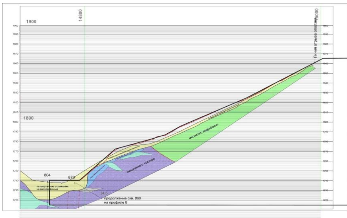
Рис. 1 – Инженерно-геологический разрез исследуемого склона сложного строения с нанесенным контуром.
