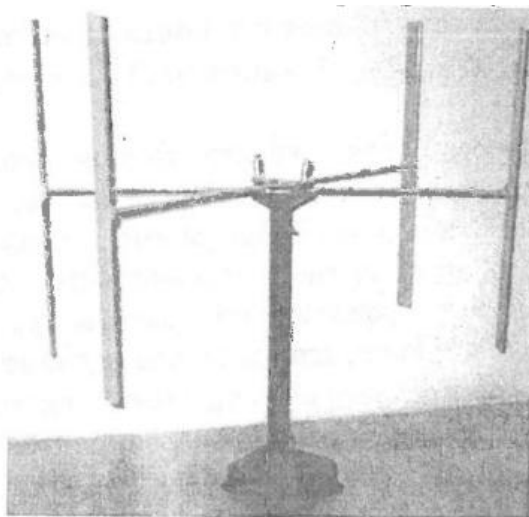
Рис. 1. Фотография действующей лабораторной модели четырехлопастной ветротурбины Дарье
