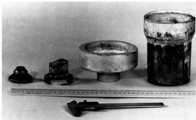
Рис.1. Детали “Стакан” (АМг5), “Корпус” (В48), “Крышка” (АК4), “Сферическая опора” (Д18Т).
