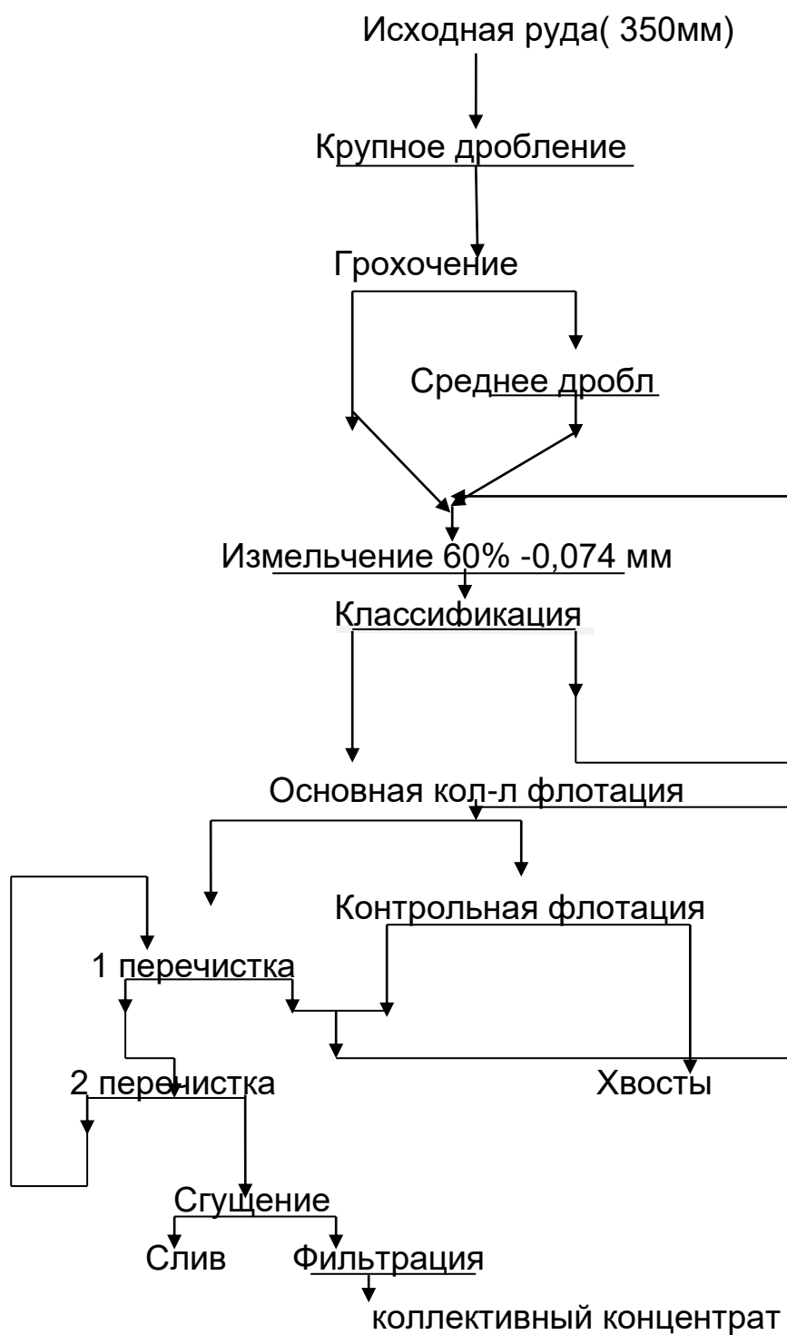
Рис.1.Технология обогащения полиметаллических руд в советское время
