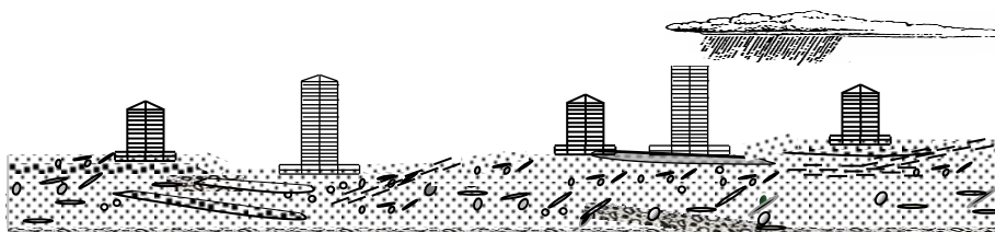
Рис. 1. Высотные здания , расположенные на неоднородной и наклонной поверхности грунтовой толщи
