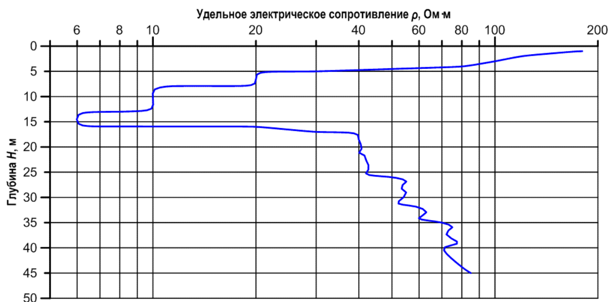
Рис. 1. Геоэлектрический разрез (усреднённый) вдоль разведочного профиля на оползневом склоне Кульмен в г. Майлуу-Суу
