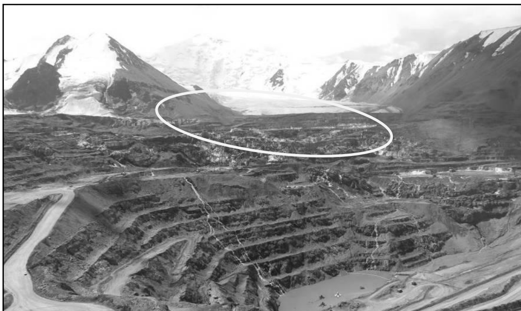
Рис.6. Фото Центрального карьера 09.08.2012 г. с видом участка сползающих в карьер отвалов и льда. На борту ЦК хорошо видны потоки воды, стекающие на дно ЦК.
