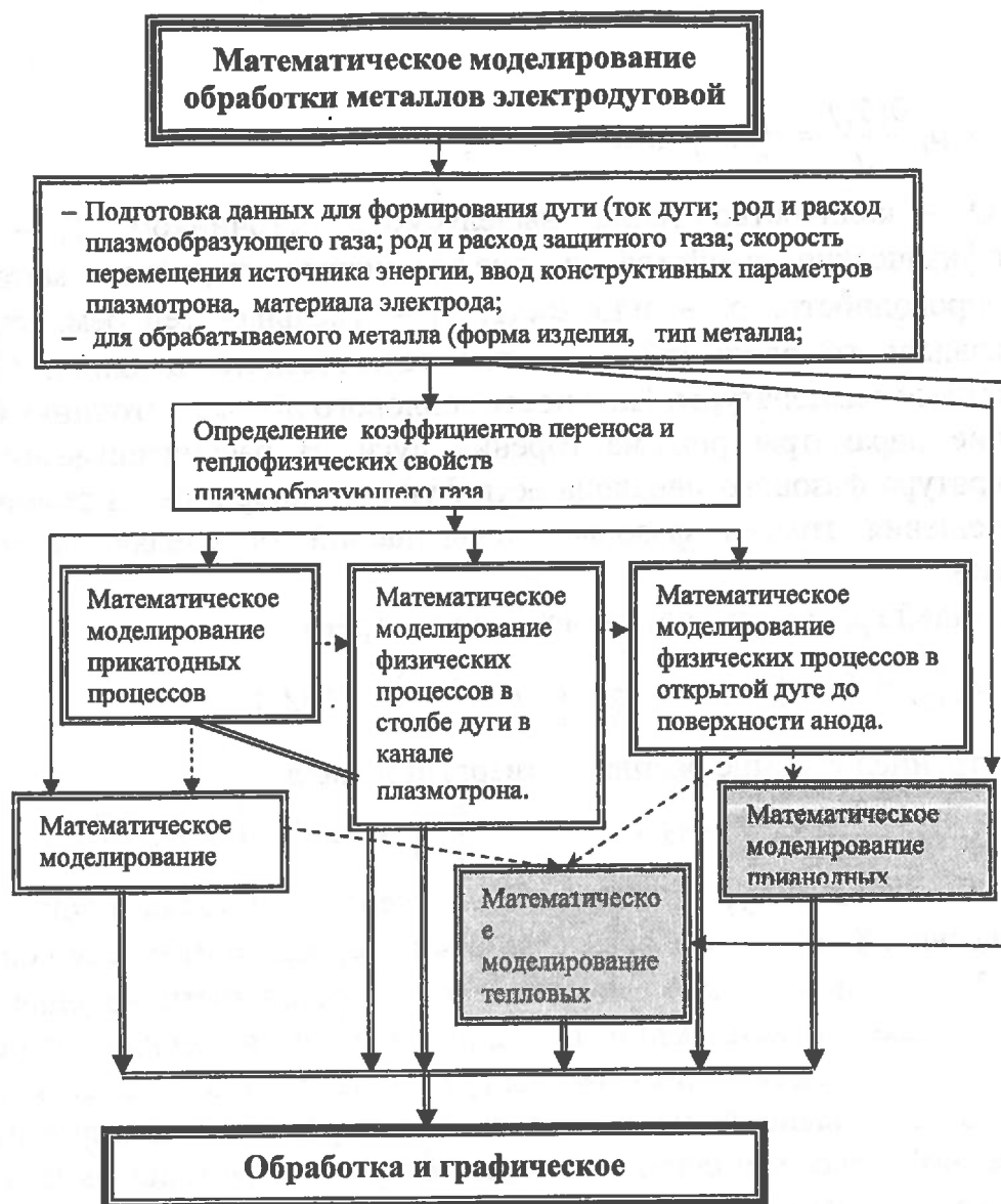
Рис. 2. Общая схема математического моделирования процесса обработки материала электродуговой плазмой
